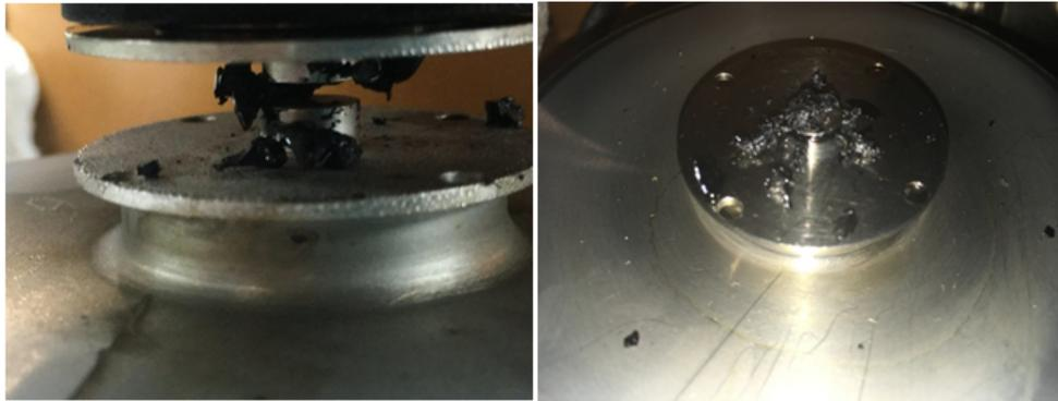
**Figura 21.** Muestra de betún fracturado luego del ensayo de Fatiga a Esfuerzo Controlado
